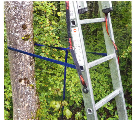
Einsatz der Leiter: Die Sicherung mit einem kleinen Spanset bringt mehr Sicherheit als eine zweite Person.
