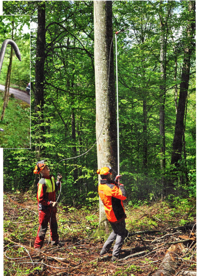
Die Kursteilnehmer konnten sich in der Handhabung der Schubstange üben. Die Methode funktioniert bei allen Bäumen. Es braucht eine Hilfsperson. Handschuhe und Helm sind zwingend!
